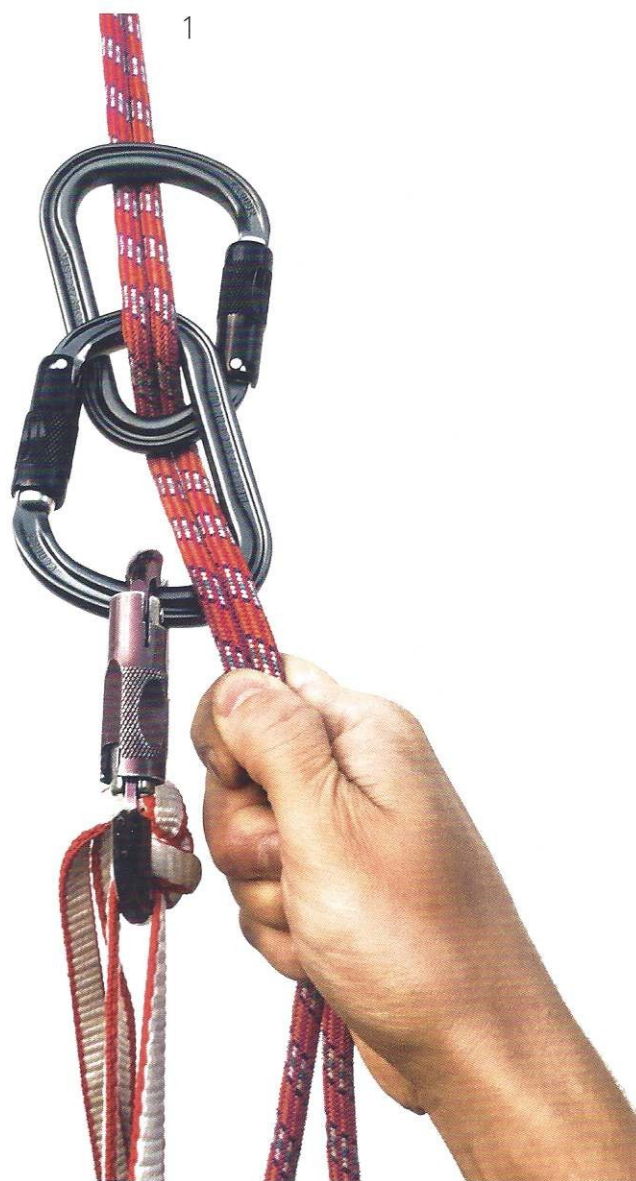
Abb. 1 Mit drei Verschlusskarabinern (am besten Safelockkarabiner verwenden) lässt sich ein provisorisches Abseilsystem aufbauen.
