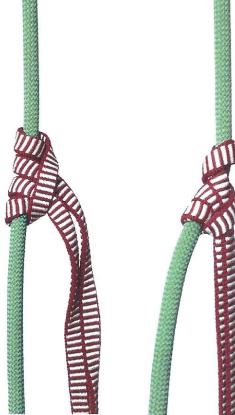
Abb. 2 Konventioneller Prusik mit Bandschlinge ohne Einbeziehung der Doppelung an der Naht. Links unbelastet und rechts unter Belastung: der Knoten verklemmt sich stärker und ist dann schwieriger zu lösen bzw. zu verschieben wie der FB-Prusik.
