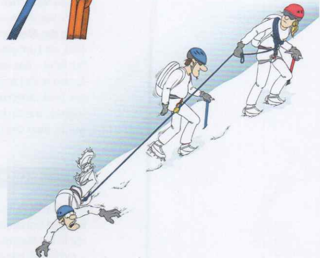
Abb. 5, 6 Wenn das Seil gerade nach oben läuft und der zweite Nachsteiger stürzt, läuft die Kraft durch die Weiche. Der Weichenmann wird nicht mitgerissen und der Führer muss nur eine Person halten. Wenn der Seilzweite allerdings aufgelaufen ist, dann wird das Halten des Sturzes schwierig. Der Führer wird durch den Zweiten behindert und kann beispielsweise nicht mehr über das Seil steigen, um sofort in Liegestützposition zu gehen, wenn der Seilzug auf den Sicherungsring (Anseilring) des Führers wirkt.
