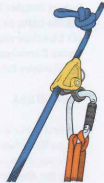
Abb. 4 Rockgrab mit Stoppknoten (Sackstich).
